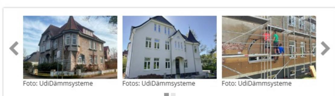
Nach einem Eigentümerwechsel wurde eine Gründerzeit-Villa im niedersächsischen Diepholz energetisch saniert. Mit einer Holzfaserdämmung hat das Gebäude nun einen geringeren Primärenergiebedarf als ein KfW-Effizienzhaus 100. Zum Einsatz kam das Dämmsystem „UdiReco.“
