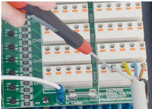
Raumthermostat anschließen, Kabel 5x1,5 mm<sup>2</sup>
