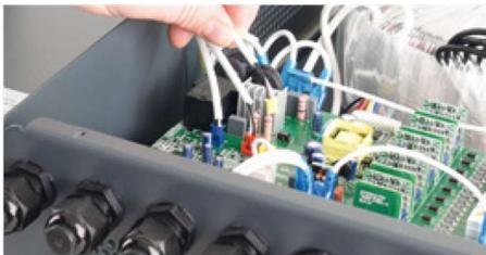
Steckverbindungen der LED-Anzeige (grün, rot, gelb) mit dem richtigen LED-Anschluss anschließen.
