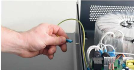
Schutzleiter am Gehäusedeckel anschließen.
