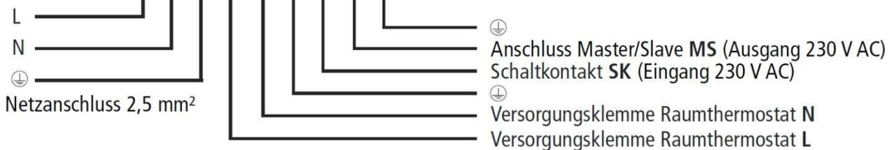
Anschlüsse 36 V (Beispiel **UdiSUN** Netzteil AP UP 800 W)
