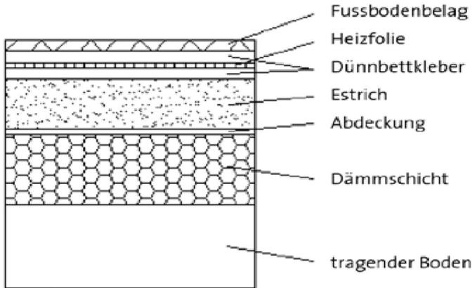
Wärmedämmung und Verlegung als Direktheizung im Dünnbettkleber.
