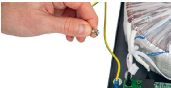
Schutzleiter am Gehäusedeckel anschließen
