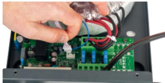
Steckverbindungen der LED-Anzeige mit dem LED-Anschluss anschließen.
