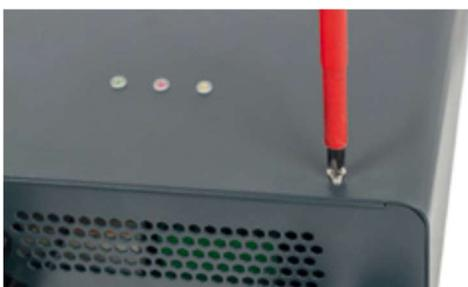
Gehäusedeckel aufsetzen und das Gerät mit den Geräteschrauben verschließen.
