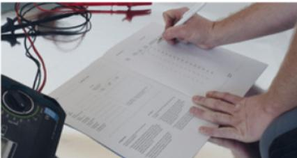
Widerstände erneut messen und im Prüfprotokoll sowie der Montageskizze dokumentieren. Sollwerte der Montageanleitung entnehmen.
