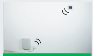
Funkübertragung mit 868 MHz für bis zu 35 m Reichweite
