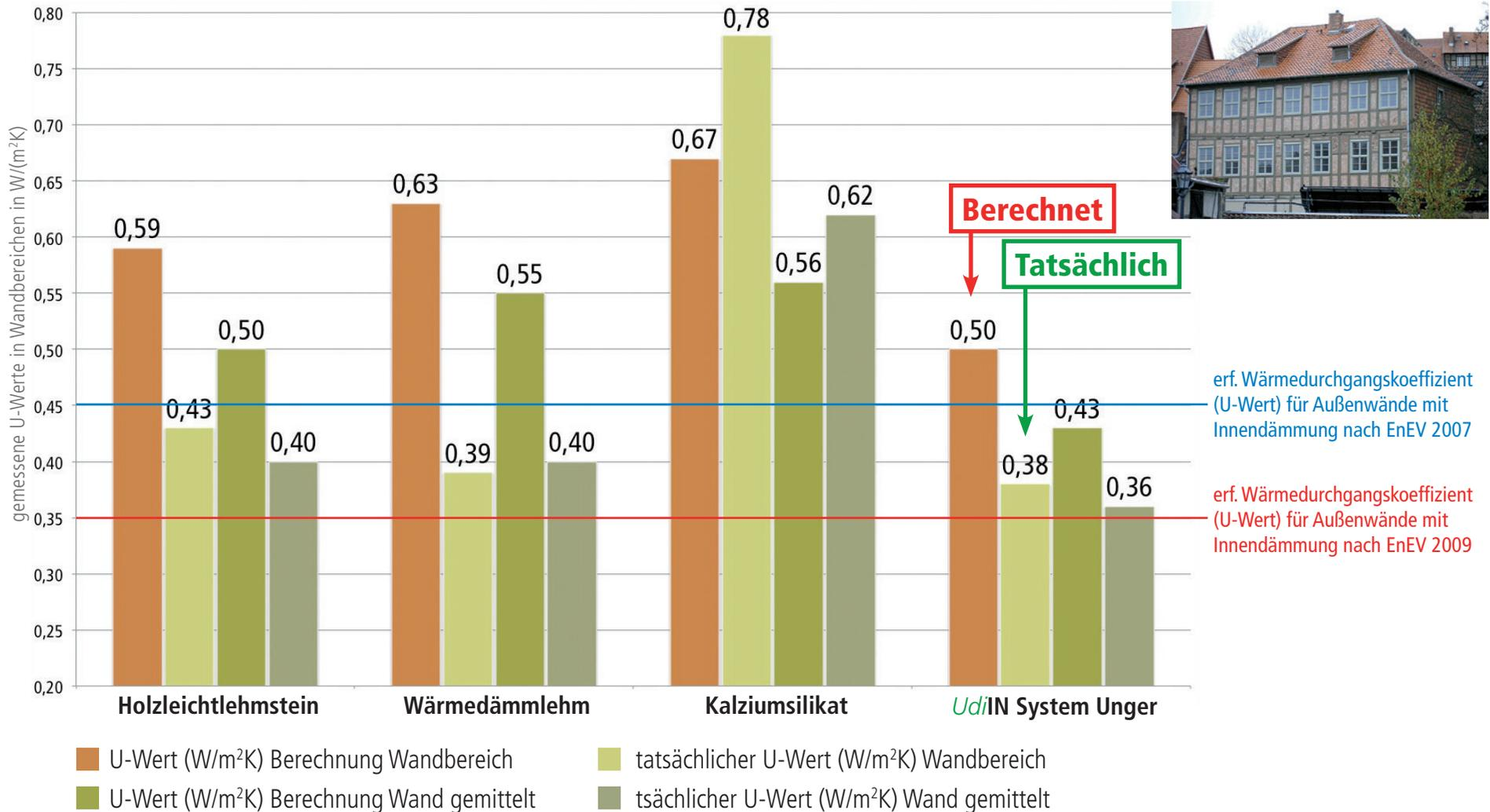
Quelle: Grafik 22 Wärmedurchgangskoeffizienten (U-Werte) berechnet im reinen Wandbereich (Ausfachung) und gemittelt (60% Ausfachung+40% Holzkonstruktion) im Vergleich zu den entsprechenden U-Effektivwerten (inkl. der solaren Energiegewinne) der Dämmvarianten (DFWZ QLB)
