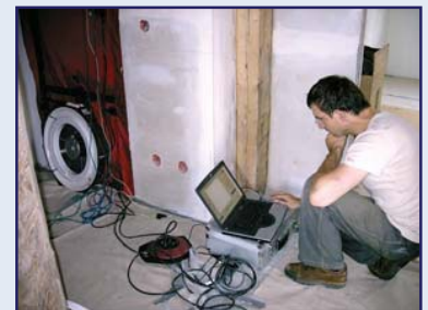
Abb. 4: Bsp. Blower Door Messung
