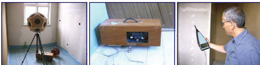
Abb. 59 bis 61: Einsatz von Lautsprecher und Normhammerwerk bei der abschließenden Messung
