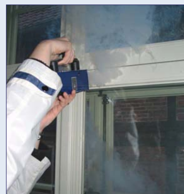
Abb. 147: Nachweis der Undichtigkeit auf der Innenseite des Kas-
