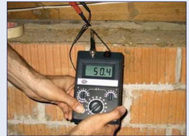
Abb. 167: Messpunkt II am Nordgiebel Tiefenmessung bei 4,5 cm
