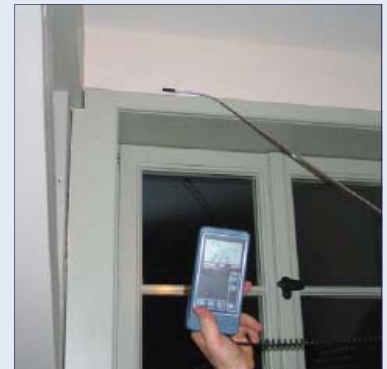
Abb. 133, 134: Deutliche Undichtheit am Anschluss des Fensters am Sturzriegel
