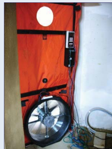
Abb. 122: Blower Door im Einsatz, Einbau des mit Folie gespannten Hilfsrahmens mit integriertem Ventilator in die Eingangstür zu Wohnung 1
