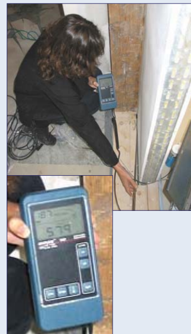
Abb. 124: Blower Door im Einsatz, Ermittlung von Leckagen mit dem Thermoanemometer. Am unteren Anschluss der leichten Trennwand sind deutlich hohe Luftbewegungen erkennbar.
