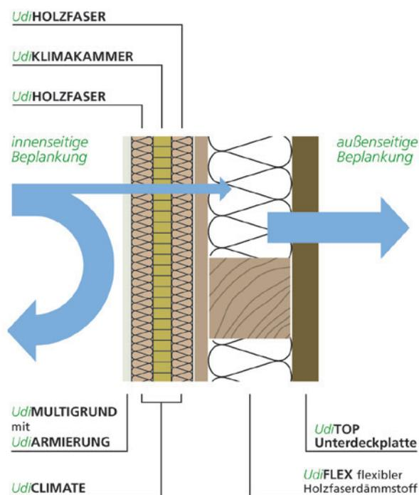
Zwischen zwei hochwertigen Holzfaserschichten aus reinem Nadelholz liegt eine Klimakammer-Zellschicht aus naturbelassenen Kartonwaben. Dieses Polster aus umschlossenen Luftsichtsäulen erzielt exzellente Wärmedämmwerte.
