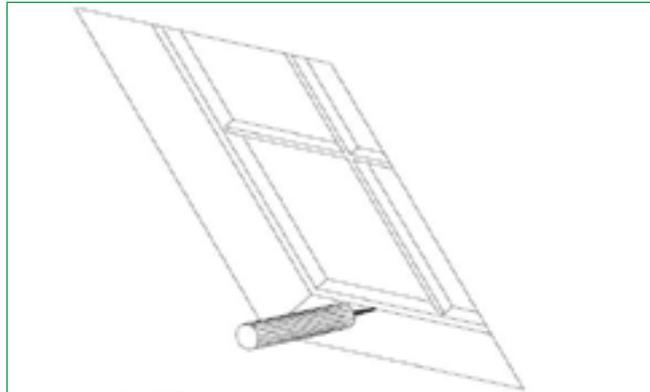
3. Sämtliche Durchdringungen, mit **UdiSTEAM® Tape elastoflex** luftdicht verkleben. Maueranschlüsse, Putz oder sägeraues Holz, wie z.B. Entlüfter, Dachfenster, ect. mit **UdiSTEAM® Butyl** oder **UdiSTEAM® FIX** dauerhaft verkleben.
