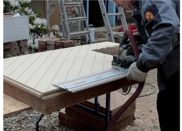
Das Gerät kann auch für präzise Zuschnitte mit Anschlag verwendet werden.
