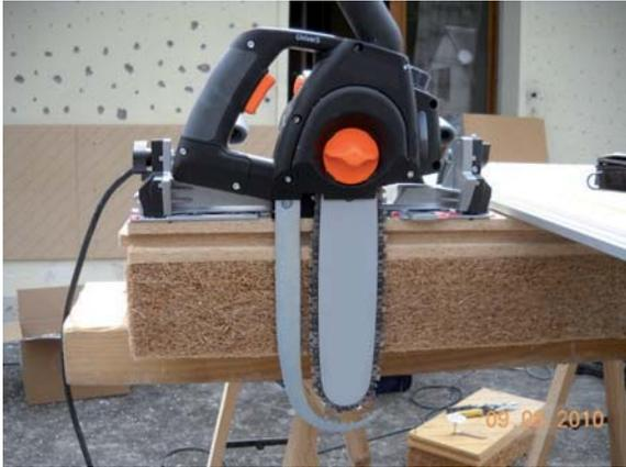
Ein komfortables und empfehlenswertes Gerät zum Zuschneiden ist die elektrische Minikettensäge.
