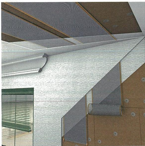
**Aufbau des Dämm-Heiz-Systems.** Die diffusionsoffene Konstruktion optimiert das Raumklima und verhindert Schimmelbildung
